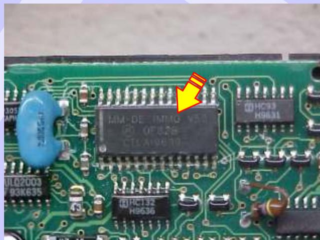
Identificando o microprocessador IM106.00C do Imobilizador neste caso o modelo 46518702
