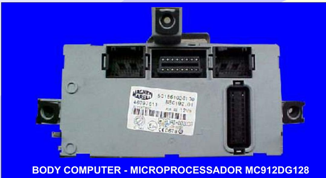
**BODY COMPUTER - MICROPROCESSADOR MC912DG128**
