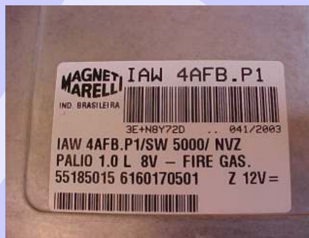
Localização da memória a ser programada na Central Fiat Magneti Marelli IAW 4AFB.P1
