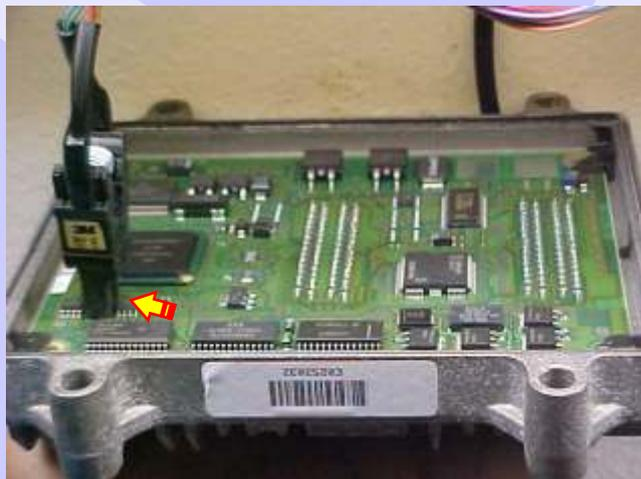
Central Delphi Multec HSFI 2.3 visualização mais ampliada da aplicação da pinça Soic 8 para leitura de senha do immobilizador
