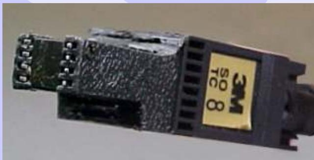
Central Delphi Multec HSFI 2.3 visualização mais ampliada da aplicação da pinça Soic 8 na memória removida para leitura de senha do immobilizador
