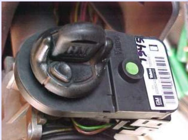
Localização do immobilizador junto ao cilindro de ignição GM da S10 e Blazer .
