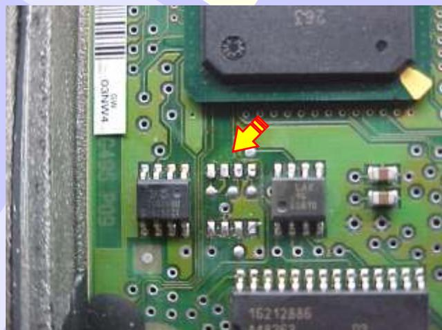
Central Delphi Multec HSFI 2.3 Aplicando a pinça soc 8 na memória removida para ler a senha do immobilizador
