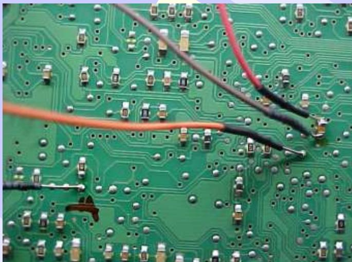
**Ilustração mais ampliada da posição dos fios soldados na Placa de Circuito do BSI**
