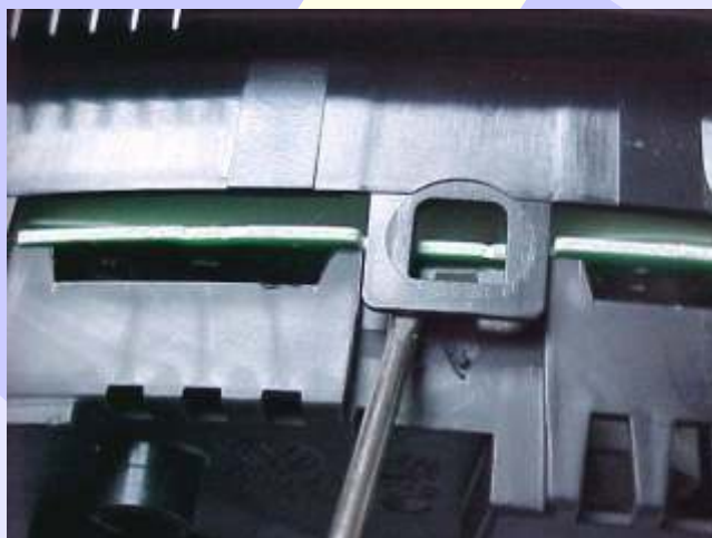
Tirando os parafusos torques e abrindo o painel de instrumentos VDO
